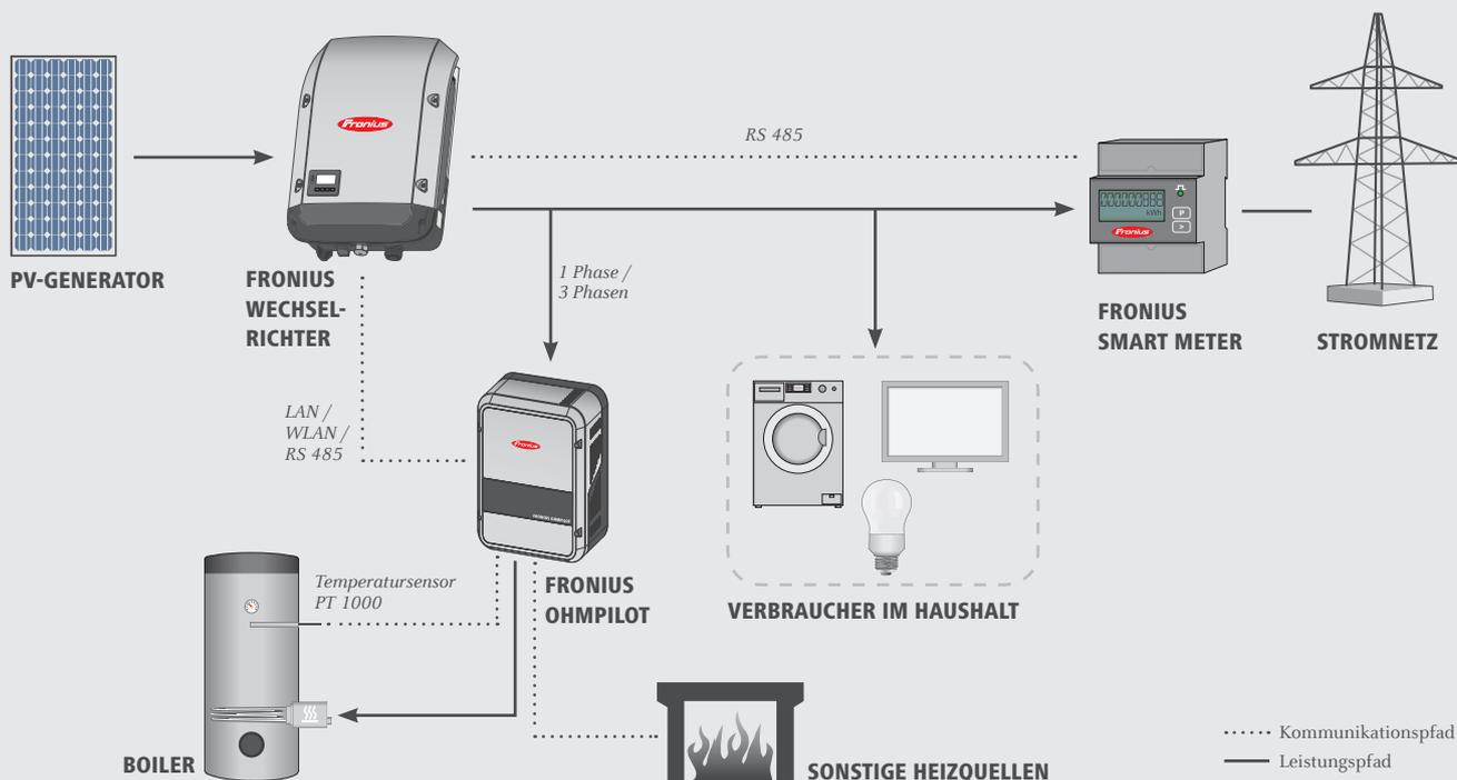
/ Bei der Installation punktet der Fronius Ohmpilot mit einfacher Inbetriebnahme über die eigene Website sowie mit einfacher Kommunikationsanbindung über WLAN. Gleichzeitig schont der Fronius Ohmpilot durch die saubere und störfreie Ansteuerung der Verbraucher das Stromnetz, damit sind Sie als Installateur für die Anforderungen von heute und morgen gerüstet.
